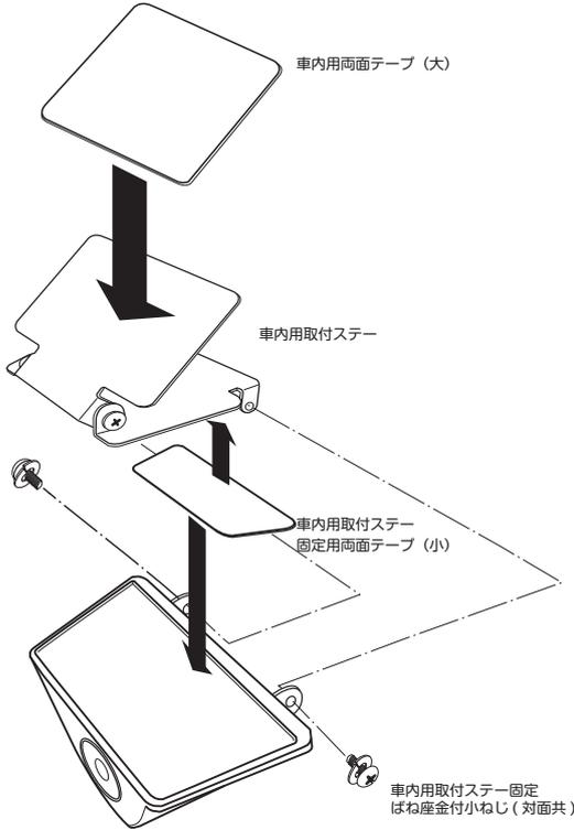
2. リアカメラを車内のリアガラスに貼り、角度を調節してねじで固定する
